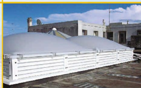
I **basamenti** per l'aerazione continua naturale del tipo a **persiana** sono realizzati in particolari profili di acciaio zincato verniciato bianco, hanno altezza standard di cm 30. Permettono un ricambio d'aria costante e continuo. Si possono montare direttamente sul cordolo in muratura, perchè alla base hanno una scossalina-gocciolatoio perimetrale.
