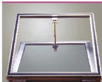
L'apertura manuale è azionata da attuatore meccanico a vite senza fine doppio effetto, corsa di circa cm 30, comandata da asta rimovibile in alluminio anodizzato grigio naturale.
